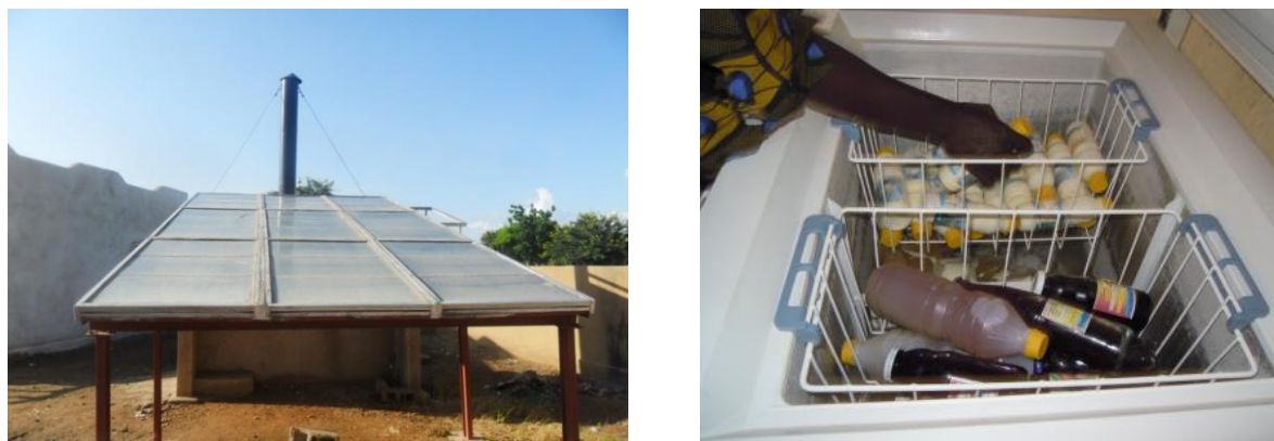
Figure 3 : Séchoir hybride (solaire / gaz) et congélateur solaire respectivement pour le séchage et le conditionnement des produits frais
